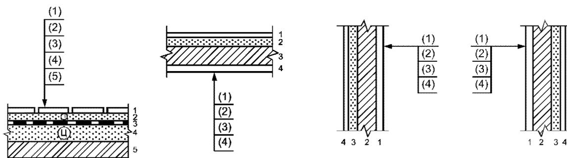
Примечание - Цифрами условно обозначена последовательность расположения слоев конструкций и надписей на полках линий-выносок.
